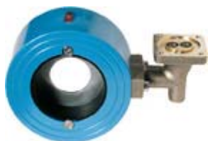
FA - межфланцевое материал: Ду 15-40 мм: медный сплав Ду 50-400 мм: чугун с эпоксидным покрытием, устанавливается между двумя фланцами, которые стягиваются болтами друг с другом
